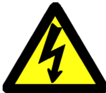
Figura 1 - Sinalização de quadros elétricos
